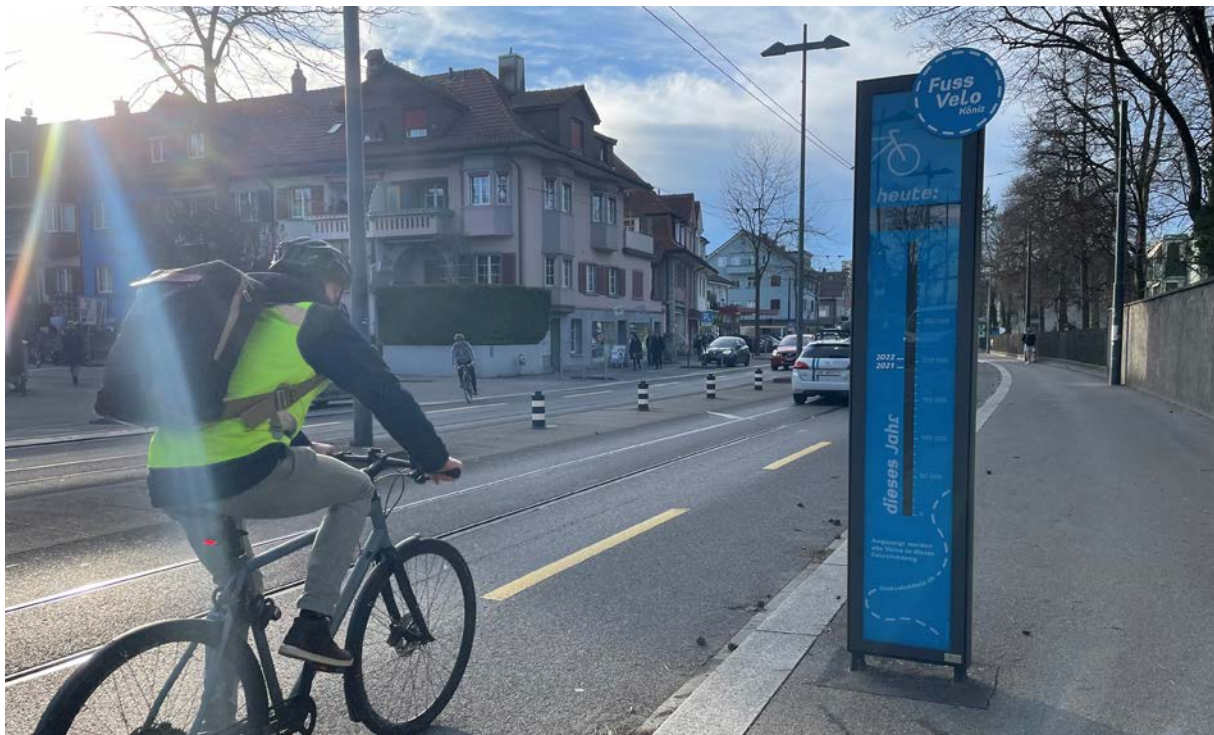
Abb. 23: Das Velo zählt! Das Velozählstellennetz wurde von 4 auf 14 Zählstellen ausgebaut, zwei davon sind sichtbar – wie diese an der Seftigenstrasse in Wabern. Foto: Tanja Hug
