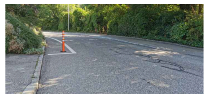
Burisholzweg, Niederscherli NACHHER: Rückmeldung der Schulkinder: «Strasse queren ist schwierig». Eine Abweislinie und ein Poller verengen die Fahrbahn und reduzieren das Tempo. Der Fussgängerschutz und die gegenseitige Sicht beim Queren konnte verbessert werden. (Foto vom 29.06.2022)
